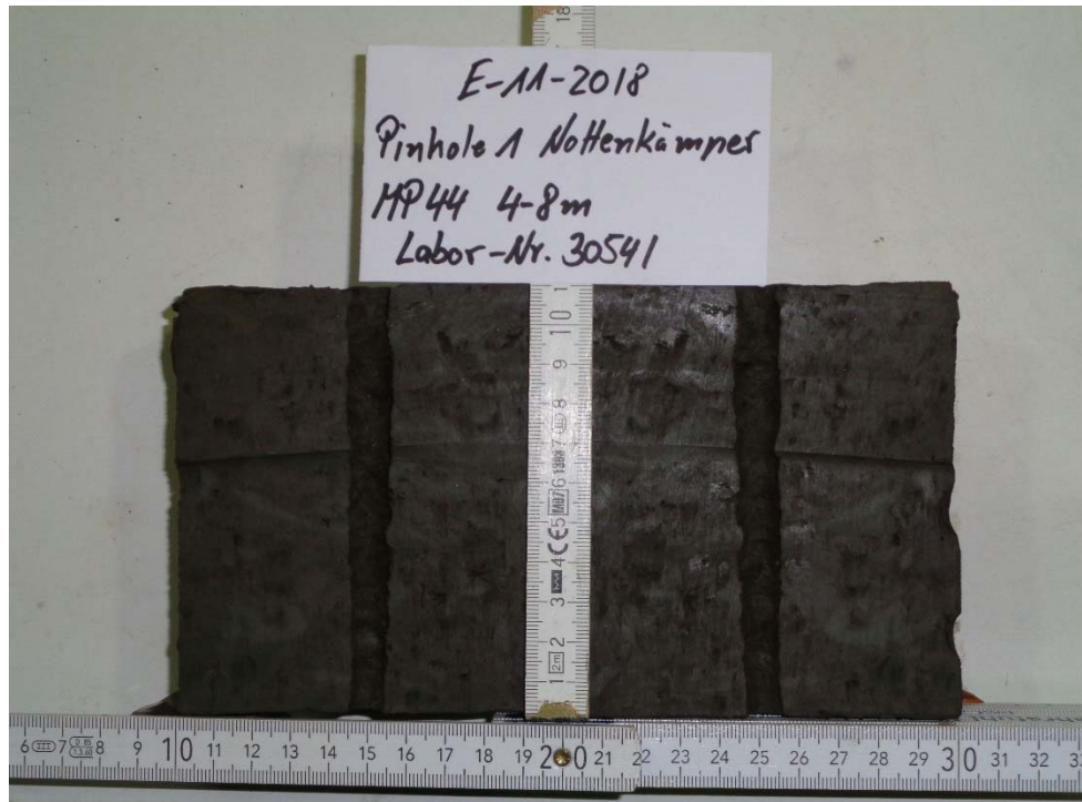
Bild 5: Durchströmungskanal nach 215 h Durchfluss im Pinhole Versuch 1
